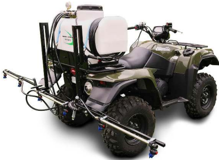
Mini-Spray MS009 - mit 2,5 m 6-düsigem 3-teiligem Faltausleger und Handlanze
