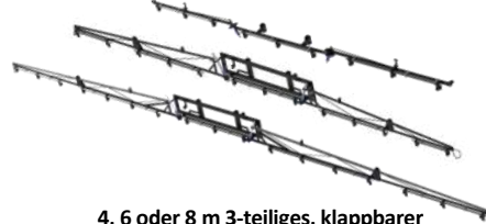
4, 6 oder 8 m 3-teiliges, klappbarer Sprüh ausleger mit Höhenverstellung und Rückfaltung. Optionale Schwerlastversionen haben eine Anti-Durchhänge-Einstellung. (für Midi-Spray 200 bis 600 Liter, traktormontiert)
