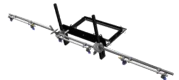
Barra de pulverización de 2,5 metros y 6 boquillas con altura regulable, dispositivos de seguridad anticollisión accionados por resorte y marco base universal (de serie en el Mini-Spray MS009)
