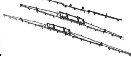
Rampe de pulvérisation repliable de 4, 6 ou 8 m divisée en 3 tronçons avec réglage de la hauteur et système de sécurité anti-collision. La version pour gros travaux en option dispose d'un réglage anti-affaissement. (pour Mini-Spray traîné 250 litres)
