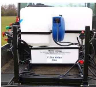
Réservoir Midi-Spray 350 litres
