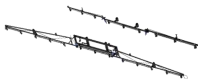
Rampe de pulvérisation repliable de 4 ou 6 m divisée en 3 tronçons avec réglage de la hauteur et système de sécurité anti-collision. La version pour gros travaux en option a un réglage anti-affaissement.
