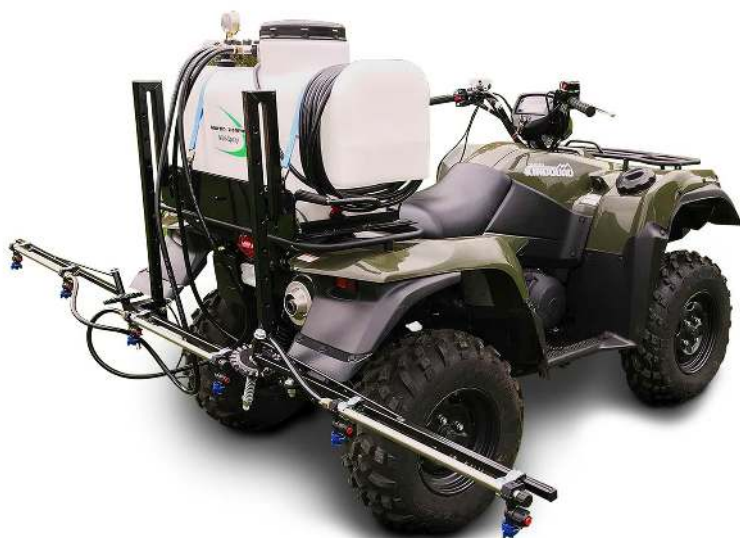
Mini-Spray MS009 - avec rampe repliable de 2,5 m à 6 buses divisée en 3 tronçons et lance à main
