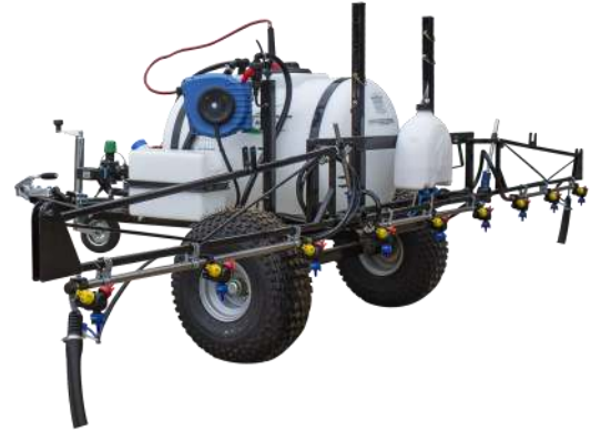
Mini-Spray traîné 125 litres avec rampe repliable de 2,5 m à 6 buses réparties en 3 tronçons et enrouleur de tuyau rétractable avec lance à main
