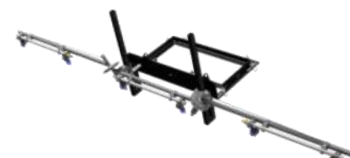
Rampe de pulvérisation de 2,5 mètres à 6 buses avec réglage de la hauteur, système de sécurité anti-collision à ressort et cadre de base universel
