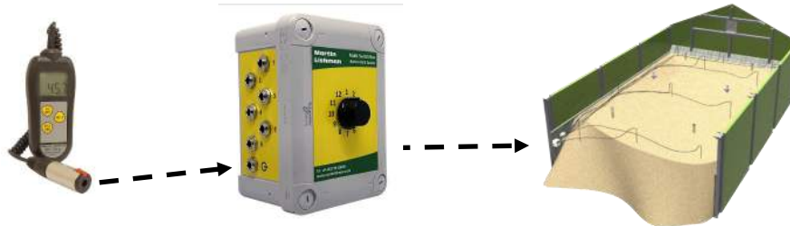
Mehrsensorschalter mit Anschlussmöglichkeiten für bis zu 12 Erntegutensoren. Nach Verbindung mit einer MiniTemp-Überwachung können über die Auswahl die Messwerte der verschiedenen Sensoren abgerufen werden.
