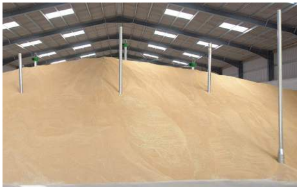
Pile-Dry-Sockel eignen sich für Erntegutlager mit einer Tiefe von 2,5 bis 12 Metern
