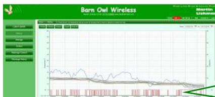
Eine interaktive Grafik zeigt die bisherigen Erntegut- und Umgebungstemperaturen sowie die Gebläsenutzung.
