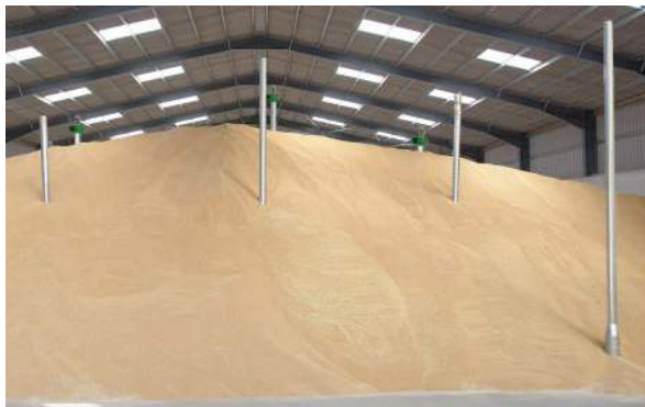
Pile-Dry Pedestals fonctionnent dans les tas de grains de 2,5 m à 12 m de profondeur
