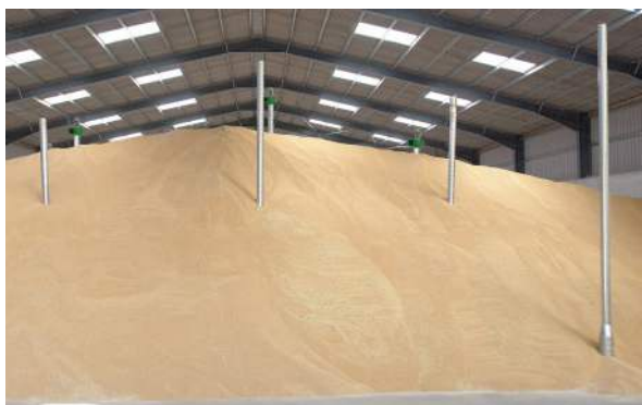
Las columnas Pile-Dry funcionan en granos a una profundidad desde 2,5 m hasta 12 m
