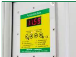
Einfach zu bedienende Regler für Temperatur, Luftfeuchtigkeit und Zeit
